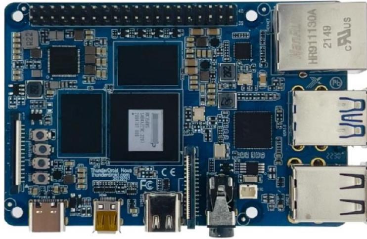
RT-Thread 边缘计算板卡主频最高可达 2.4GHz，搭配 Mali-G610 高阶 GPU 图形处理，拥有 8GB LPDDR4 内存和 64GB 高速 EMMC 存储。集成了板载 2.4G/5G 双频 WIFI，板载蓝牙 5.0，支持双摄像头，电源管理，TF 卡存储，支持 MiNi PCIE 扩展，LED 指示灯，支持 8K 输出。提供丰富的外设接口，包括：HDMI 输出、26PIN GPIO 接口、LCD 接口、DC 接口、TYPE-C 接口、千兆网口、2 个 USB2.0、2 个 USB3.0 等。提供内置 Python、OpenCV、TensorFlow、PyTorch、ncnn、rknn、JieBa、HanLP、PocketSphinx、PyAudio 等软件，具备人工智能机器视觉、语音处理、自然语言、边缘计算等教学软件环境。边缘计算设备集成人工智能中间件，包含：资源调度、视频推流、模型推理、智慧物联等组件，支持通过 WEB API 实时调用算法实现视觉、语言、自然语言处理等计算服务。
